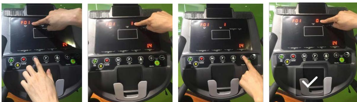
**D)** Drücken Sie einmal die Taste "M" (Abb.1), nun wechselt die Anzeige "F01" zu "F02" (Abb. 2). Drücken Sie nun einmal die Taste "R" (Abb. 3), um den Programmiermodus zu beenden (Abb. 4 & 5 & 6). Das Display zeigt nun die Werte für Geschwindigkeit und Strecke in Kilometer an und der Benutzer kann wie gewohnt trainieren.
