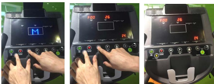
**C)** Drücken Sie einmal die Taste "M" (Abb.1), das obere, mittlere Display zeigt nun "1" an. "1" bedeutet, dass die Anzeige in Meilen erfolgt (Abb. 2). Um von Meilen zu Kilometern zu wechseln drücken Sie einmal die Taste "+" (Abb. 3). Nun zeigt das obere, mittlere Display den Wert "0" an. "0" steht hierbei für Kilometer (Abb. 4).
