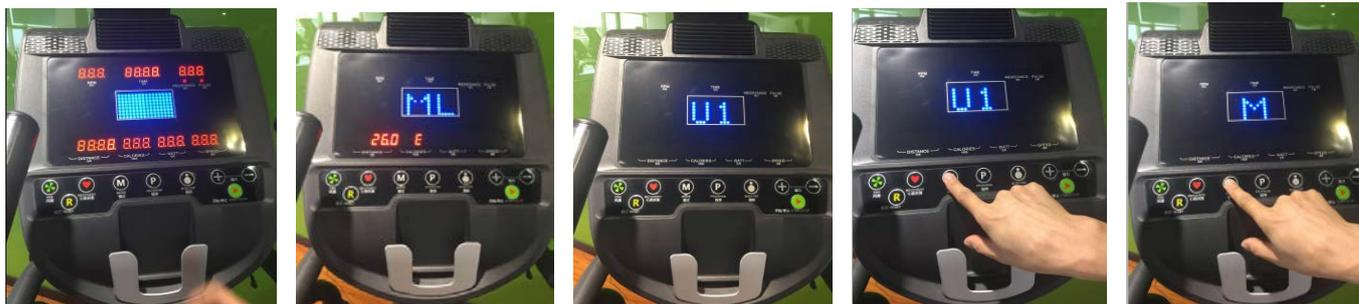
**B)** Drücken Sie die Taste "M", halten Sie diese gedrückt und drücken dann die Taste "R" (Abb. 1). Halten Sie beide Tasten solange gedrückt bis im oberen, linken Display "F00" angezeigt wird (Abb. 2 & 3).
